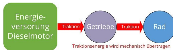
Abb. 3-1 Antriebsstrang dieselmechanisch (schematisch)
