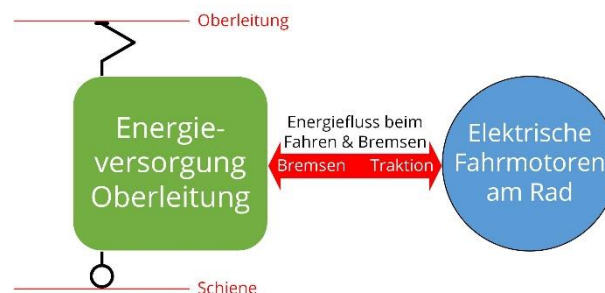
Abb. 3-5 Antriebsstrang klassischer elektrischer Elektrotriebzug (schematisch)
