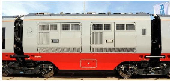
Abb. 3-17 Unterbringung der Komponenten der 2. Traktionsart in weiterem Wagenkasten 30
