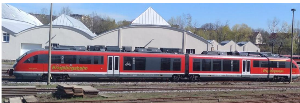
Abb. 3-23 Eco Train mit deutlich erkennbarem zusätzlichem Dachaufbau 35
